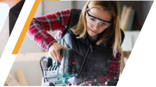
Pour les plaques qui ont une épaisseur de plus de 5 mm, une autre méthode de découpe est envisageable : la scie sauteuse. En effet, la méthode utilisée avec le cutter risque de s'avérer inefficace.
